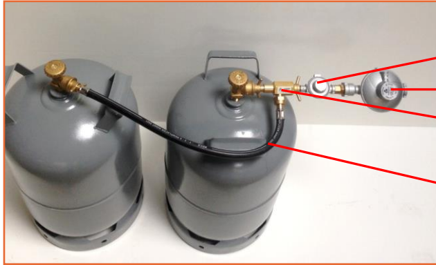
Automatisch omschakelaar 1,5bar + 2-de trapsdrukregelaar
